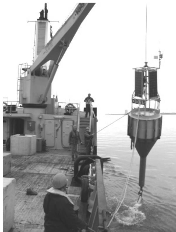
Ausbringen der FTZ-Messtonne vor Büsum mit dem Tonnenleger Triton (Vanselow)
